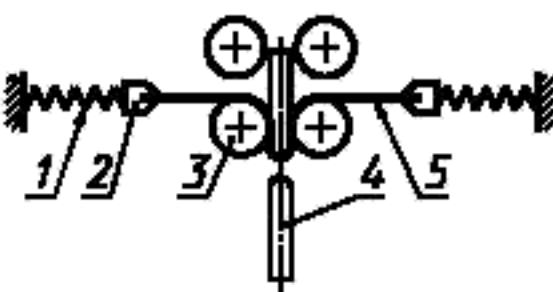
1 — пружина; 2 — зажим; 3 — ролик; 4 — изгибающая пластина; 5 — образец
