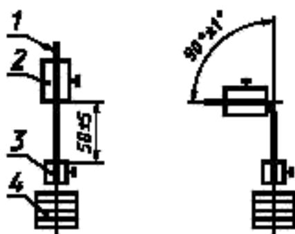
1 — испытуемый образец, 2 — верхний изгибающий зажим; 3 — нижний зажим; 4 — грузы
