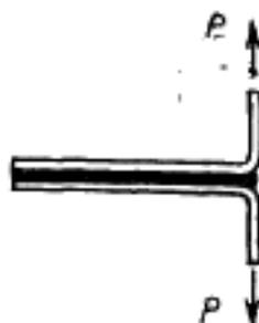
51. Прочность клеевого соединения при отслаивании
