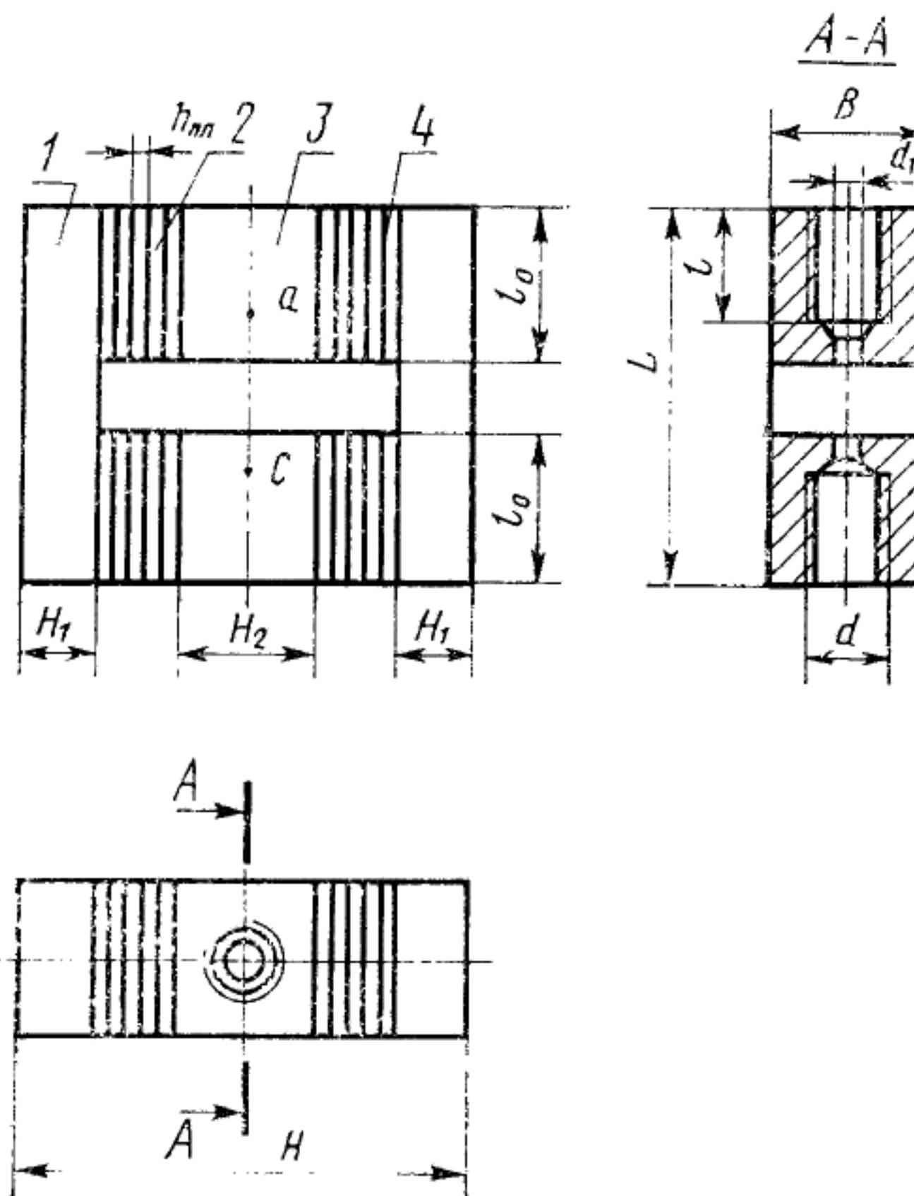
1—боковая пластина; 2—пластина; 3—крепежный вкладыш; 4—клевой слой; ас—база измерения деформации (20—30 мм)
