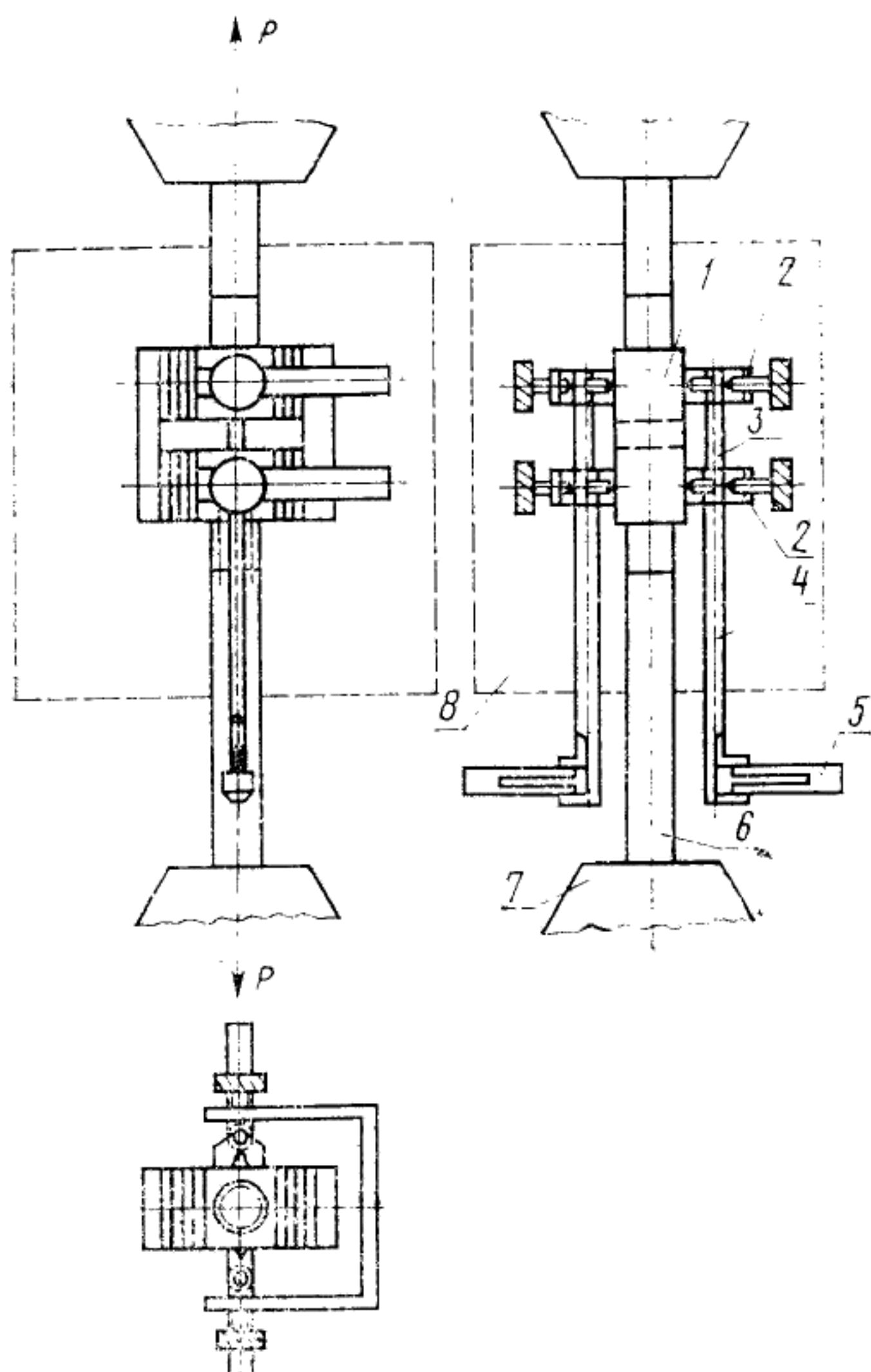
1—образец; 2—прижимная планка; 3—внутренняя штанга с опорной призмой; 4—внешняя штанга с опорной призмой; 5—прибор для измерения деформации; 6—тяга с шарниром; 7—захват испытательной машины; 8—крио-, термокамера
