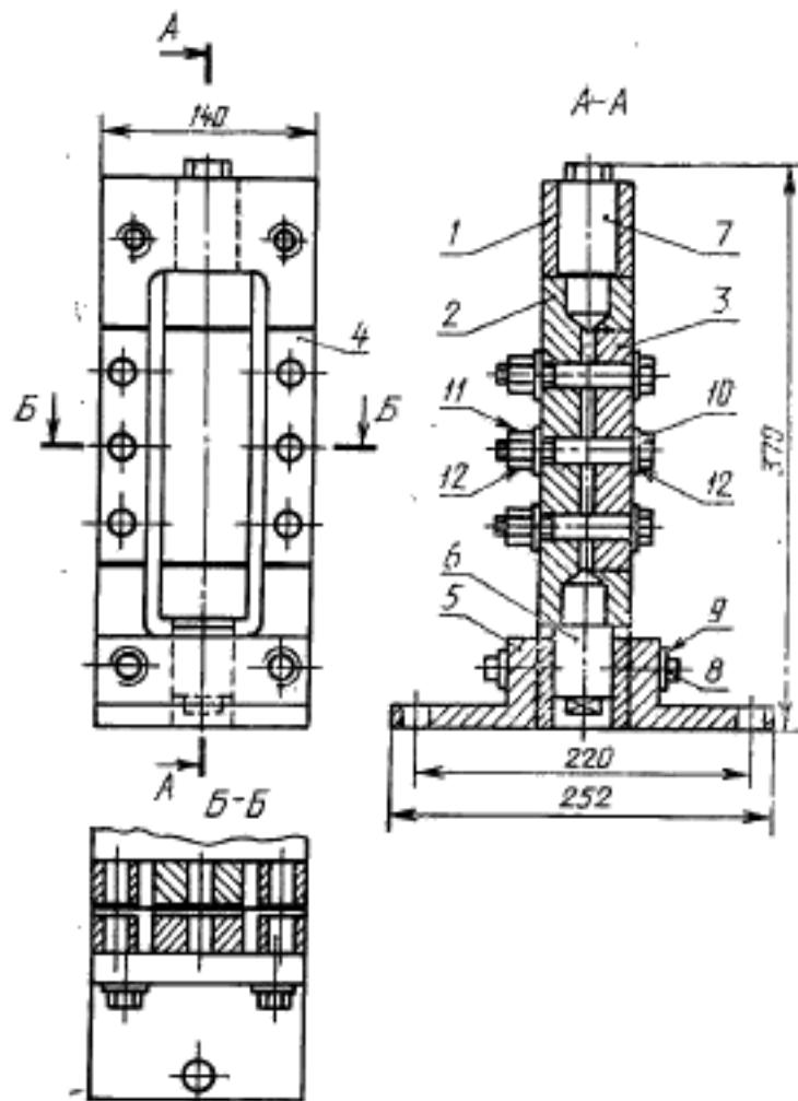
1—обойма; 2—вкладыш; 3—плита средняя; 4—плита крайняя; 5—башмак; 6—закл. нижний; 7—закл. верхний; 8—болт M12×1,5×44; 9—шайба 12; 10—болт M16×1,5×80; 11—гайка M16×1,5; 12—шайба 16
