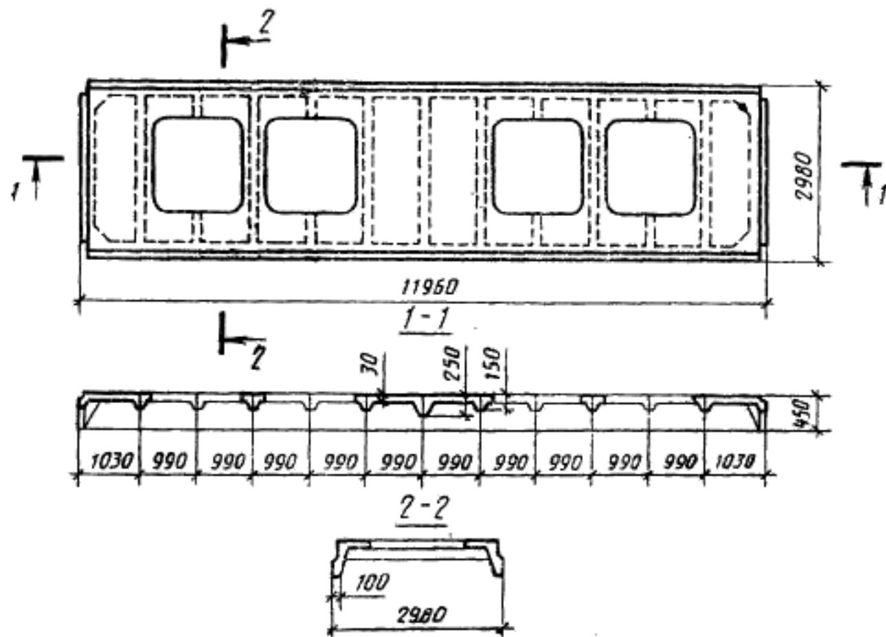
С двумя проемами размерами 2600×2700 мм
