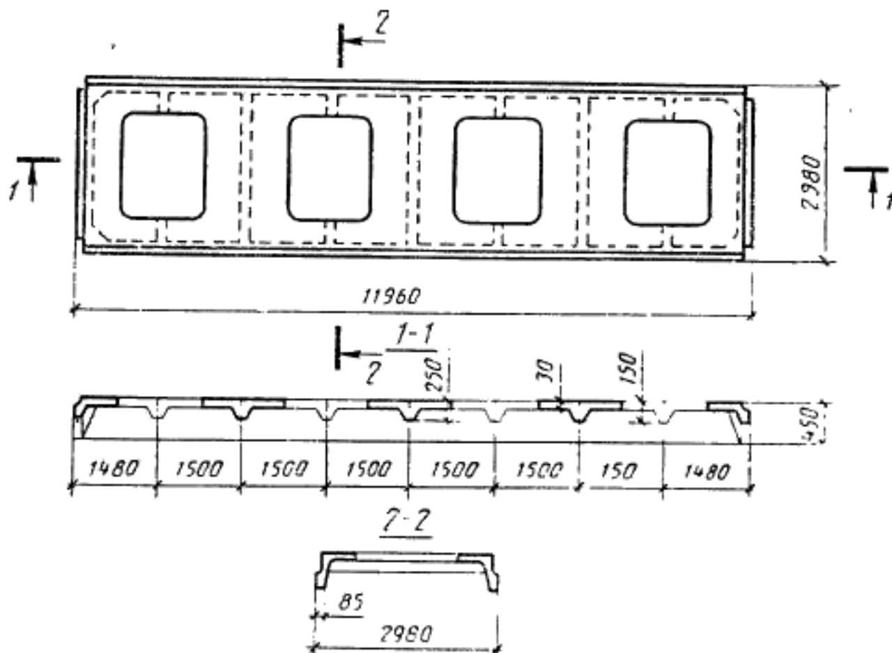
С двумя проемами размерами 2600×2700 мм
