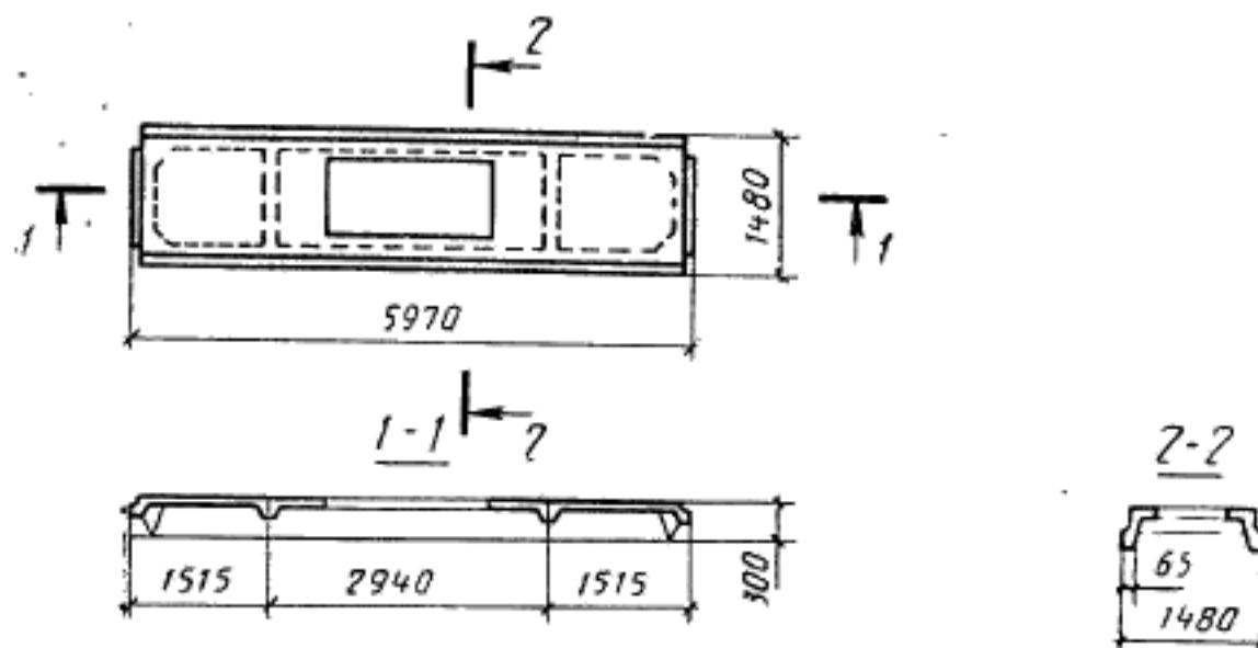
С двумя проемами размерами 1200×1700 мм
