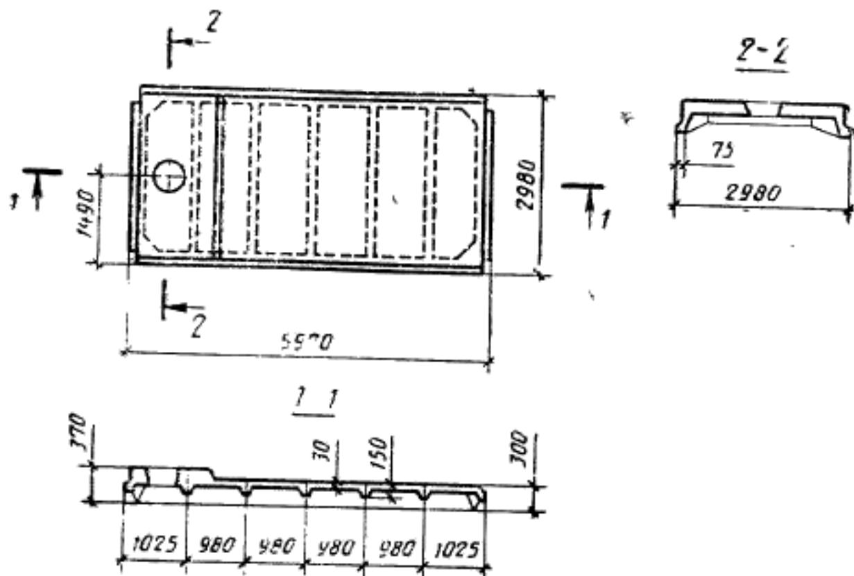
С проемом диаметром 1000 или 1450 мм
