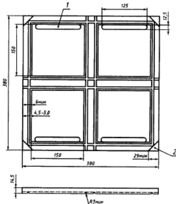
1 — углубление для выпрессовки условного обозначения глубиной на 0,5 мм ниже плоскости основания гнезд (углубления необязательны);
