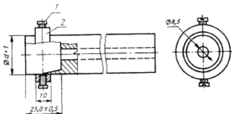
$d$  — диаметр металлического корпуса вентилей; 1 — винт; 2 — финишное кольцо.
