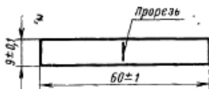
принимают соответствующие размеры штанцевого ножа. Условия вырезания образцов должны соответствовать ГОСТ 269—66, разд. 1.
