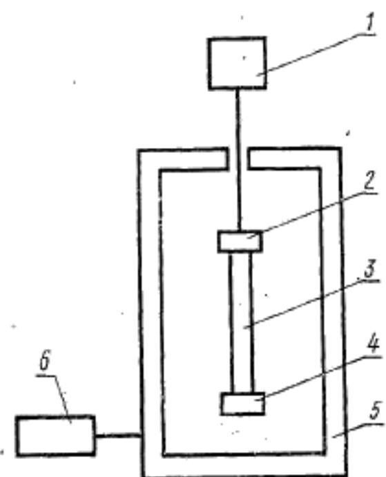
1—узел для измерения усилия; 2—верхний зажим; 3—растянутый образец; 4—нижний зажим; 5—термокамера; 6—узел для измерения и регулирования температуры в камере
