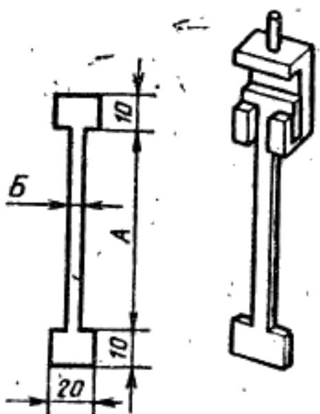
$A = (50,0 \pm 0,5)$  мм;  $(57,0 \pm 0,5)$  мм или  $(59,5 \pm 0,5)$  мм
