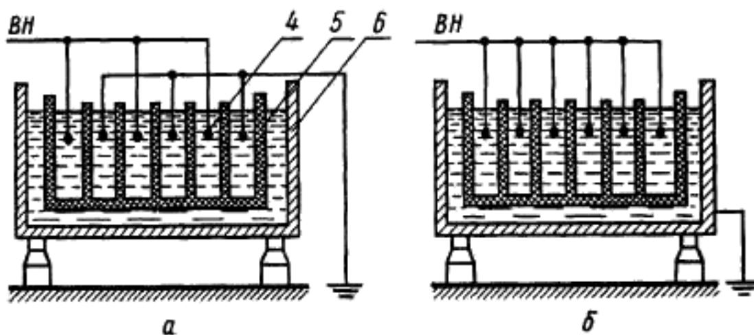
*a* — схема подключения электродов к источнику высокого напряжения при испытании перегородок моноблока; *б* — схема подключения электродов к источнику высокого напряжения при испытании корпуса моноблока.
