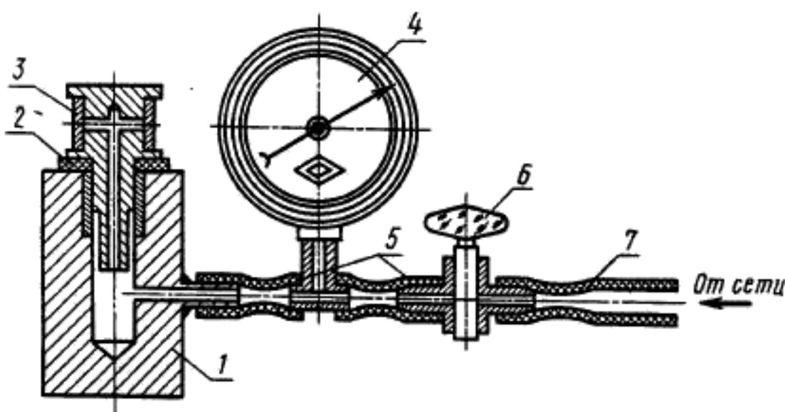
1 — патрон; 2 — резиновая шайба; 3 — пробка; 4 — манометр со шкалой на  $101 \text{ кПа}$  (1 атм);
