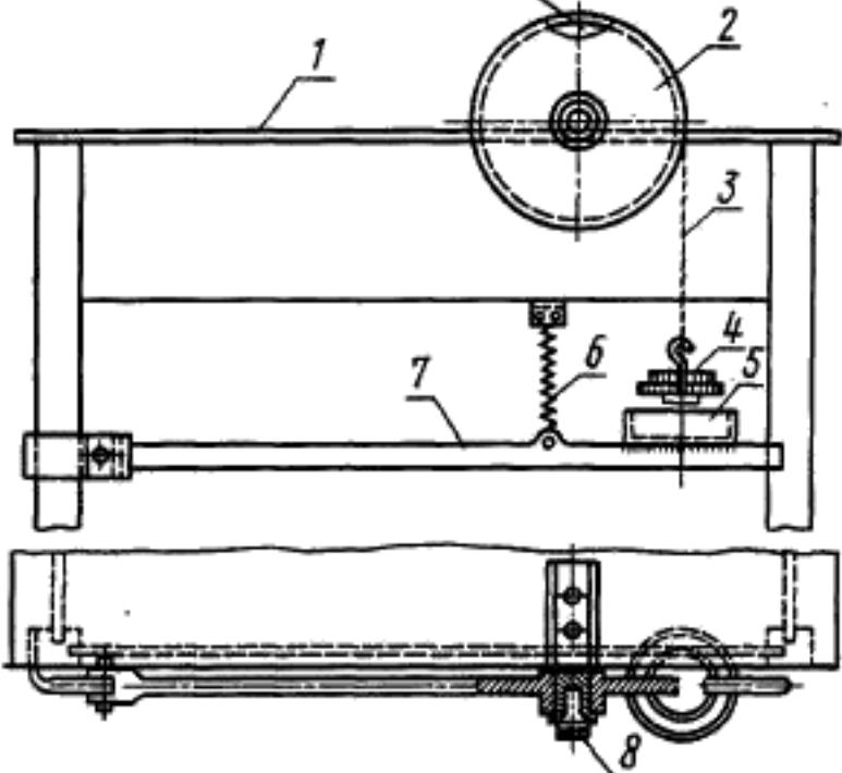
1 — стол; 2 — диск диаметром 200 мм; 3 — капроновая нить; 4 — груз массой 1,2 кг; 5 — площадка; 6 — пружина; 7 — рычаг; 8 — испытательная пробка
