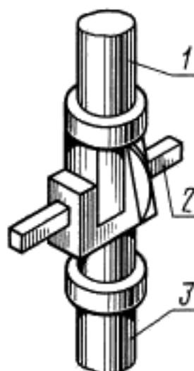
Приспособление состоит из двух стальных штанг (верхней 1 и нижней 3), которые укрепляются соответственно на месте верхнего и нижнего зажимов разрывной машины.
