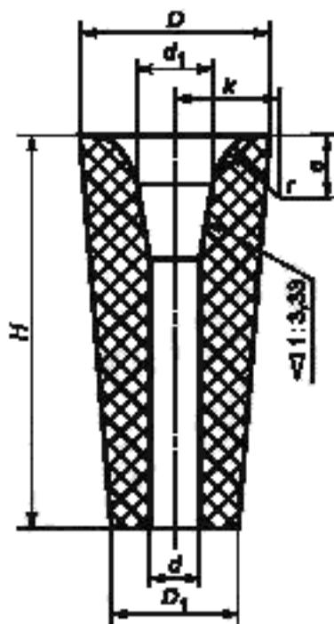
Рисунок 3 — Стакан стопорный номеров 15—23
