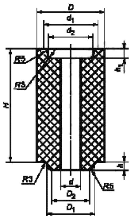
Рисунок 1 — Стопорная трубка номеров 1—8
