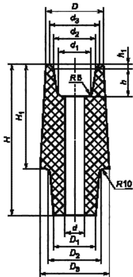
Рисунок 6 — Стопорный стакан номеров 33, 34
