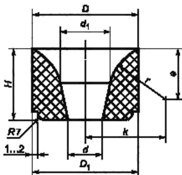
Рисунок 7 — Стопорный вкладыш номеров 35, 36
