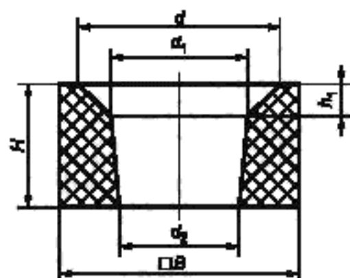
Рисунок 8 — Стопорный гнездовой кирпич номеров 37—44
