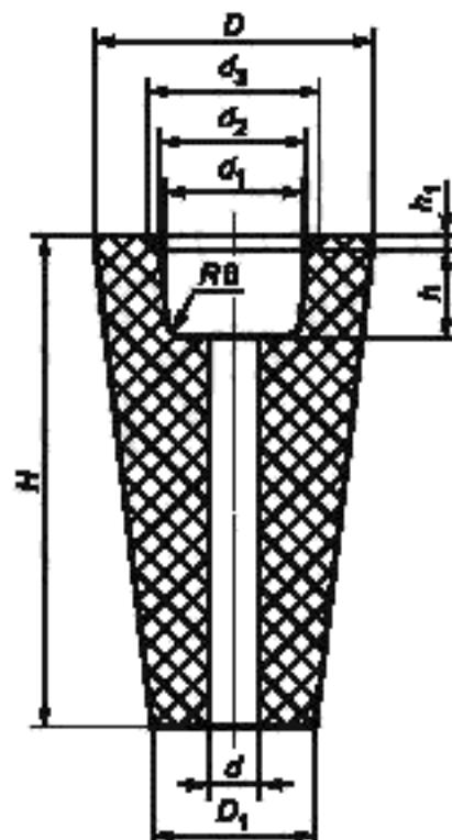
Рисунок 5 — Стопорный стакан номеров 25—30
