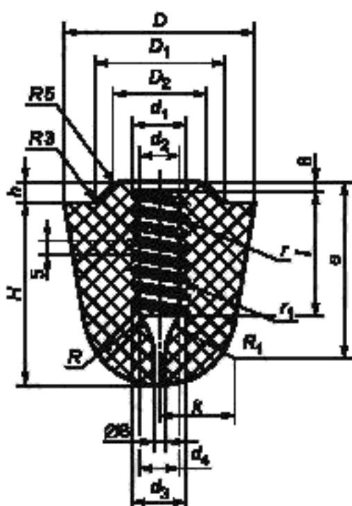
Рисунок 2 — Стопорная пробка номеров 9—14
