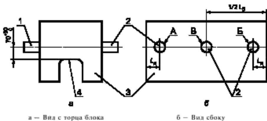
1, 2 — электроакустические преобразователи; 3 — блок; 4 — дно паза;  $L_b$  — длина блока, А, Б,  $B^*$  — места контроля;
