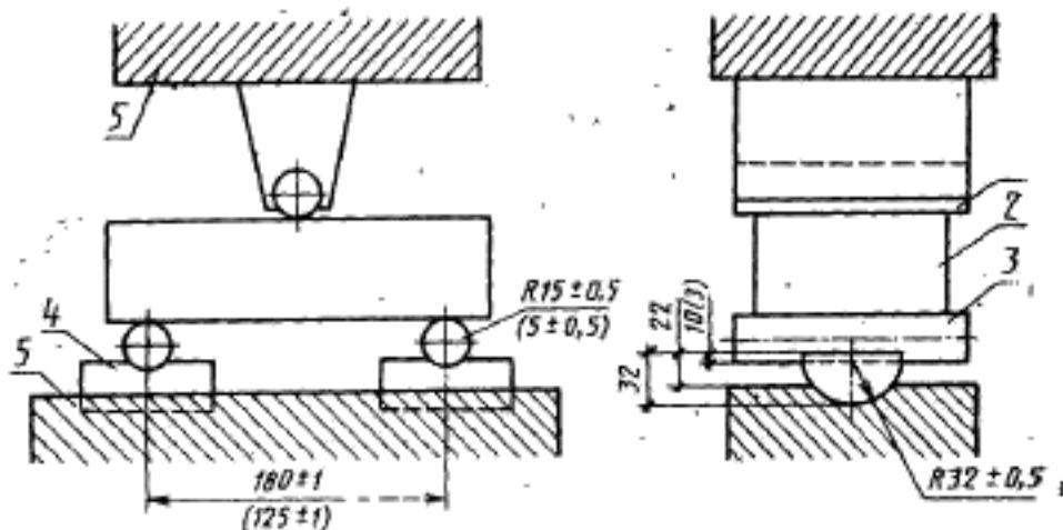
1 — опора для приложения нагрузки (нажимная); 2 — образец для испытания; 3 — опоры, поддерживающие образец; 4 — дополнительный опорный элемент; 5 — панели испытательной машины
