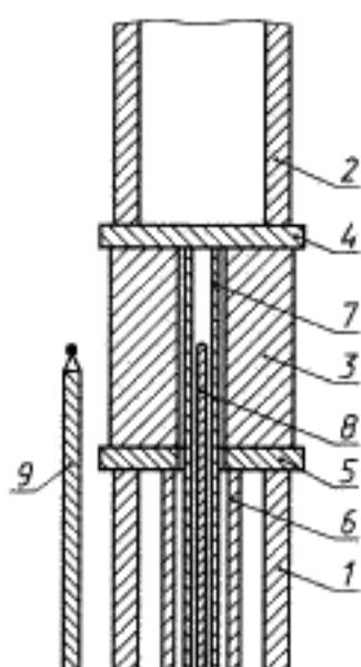
1 — нижний штампель; 2 — верхний штампель; 3 — образец; 4 — верхняя прокладка; 5 — нижняя прокладка; 6 и 7 — трубы, передающие деформацию; 8 — термопары для измерения температуры образца; 9 — термопары для управления печью
