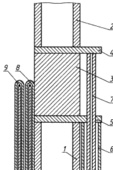
1 — нижний штампель; 2 — верхний штампель; 3 — образец; 4 — верхняя прокладка; 5 — нижняя прокладка; 6 и 7 — трубы, передающие деформацию; 8 — термопары для измерения температуры образца; 9 — термопары для управления печью
