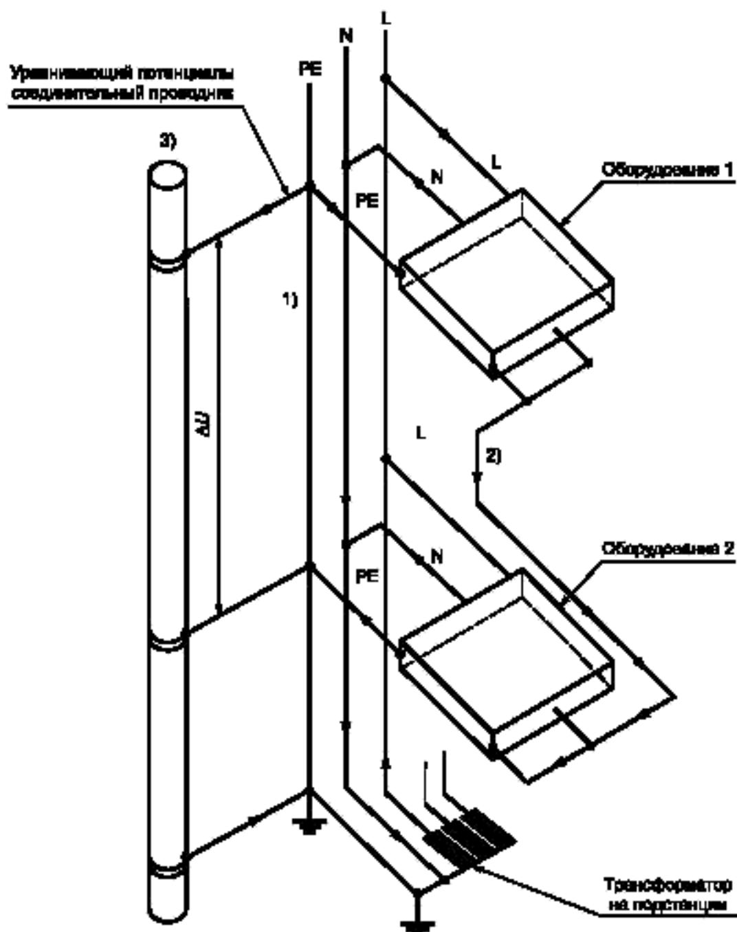
1) — устранение падения напряжения  $\Delta U$  вдоль РЕ; 2) — соединительный проводник на ограниченной площади;
