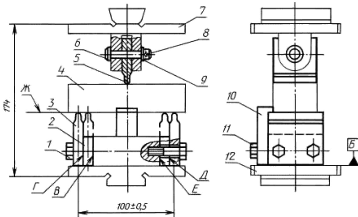
1 — болт; 2 — планка; 3 — клин нижний; 4 — образец; 5 — клин верхний; 6 — падец; 7 — плита верхняя; 8 — шплинт 2,5 × 15; 9 — шайба; 10 — упор; 11 — болт; 12 — плита нижняя
