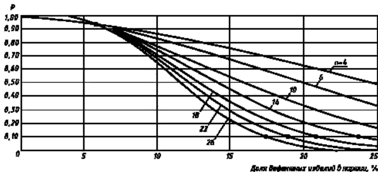
Рисунок 7 — Кривые оперативных характеристик одноступенчатых планов контроля таблицы 9 для  $AQL = 6,5\%$ : с установленным односторонним пределом для единичных значений и известным средним квадратическим отклонением<sup>11</sup>
