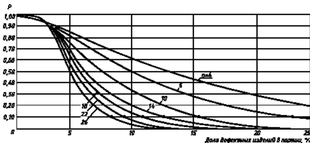
Рисунок 5 — Кривые оперативных характеристик одноступенчатых планов контроля таблицы 9 для  $AQL = 2,5\%$ ; с установленным односторонним пределом для единичных значений и известным средним квадратическим отклонением<sup>10</sup>
