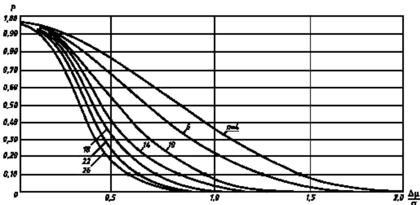
Рисунок 2 — Кривые оперативных характеристик для одноступенчатых планов выборочного контроля из таблицы А4: испытание при гарантированном среднем значении при известном среднем квадратическом отклонении<sup>1)</sup>
