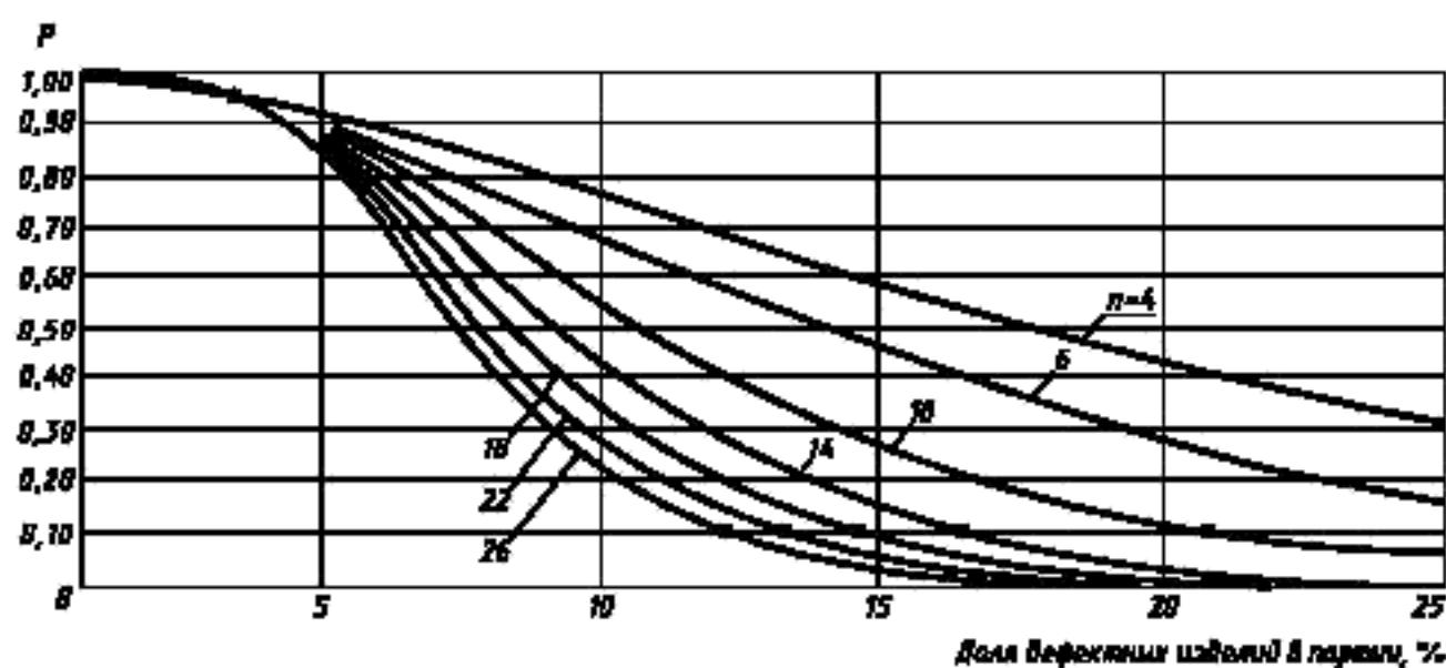
Рисунок 6 — Кривые оперативных характеристик одноступенчатых планов контроля таблицы 9 для  $AQL = 4,0\%$ ; с установленным односторонним пределом для единичных значений и известным средним квадратическим отклонением<sup>10</sup>
