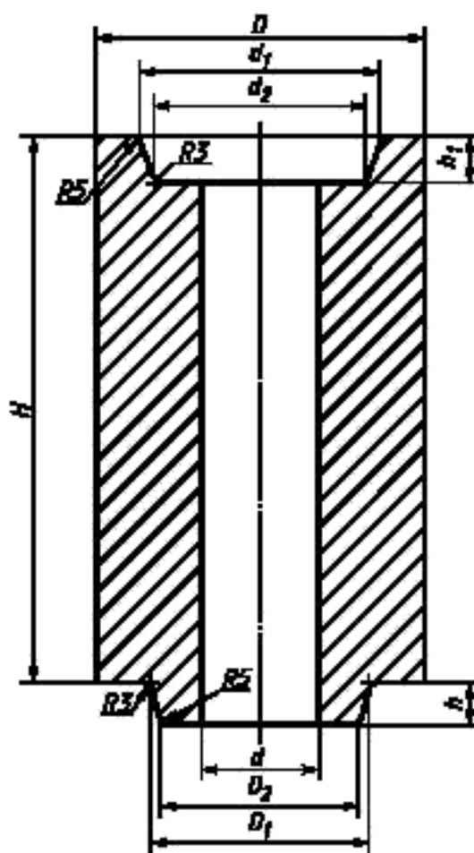
Рисунок 1 — Стопорная трубка номеров 1—8 и 8—1
