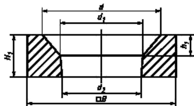
Рисунок 10 — Верхняя часть составного гнездового кирпича номер 45
