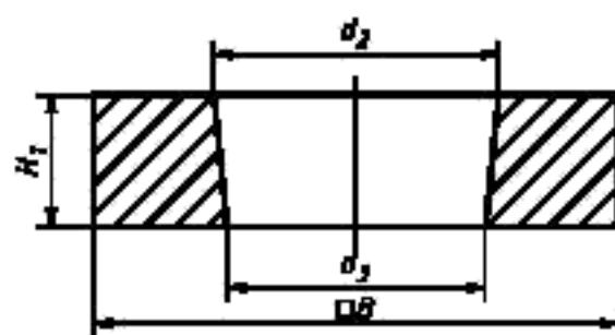
Рисунок 11 — Нижняя часть составного гнездового кирпича номер 46
