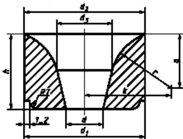
Рисунок 8 — Вкладыш номеров 35 и 36
