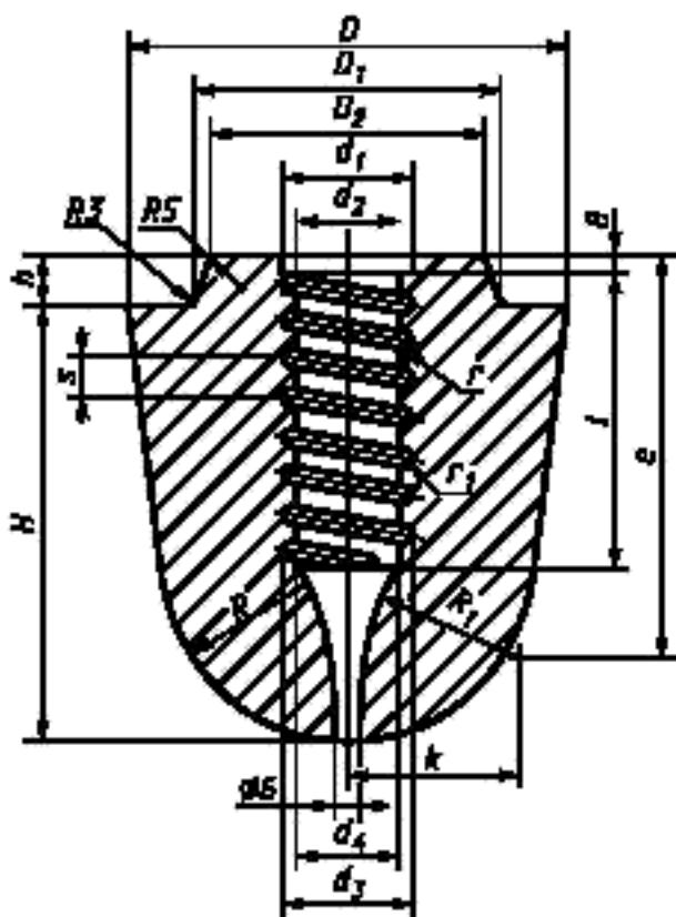
Рисунок 2 — Пробка номеров 9—14, 14—1, 14—2
