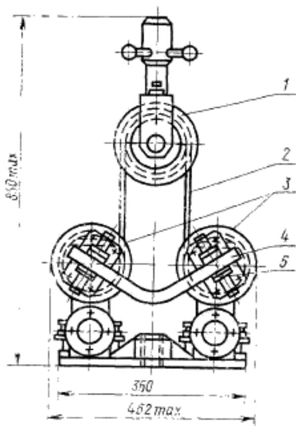
1—блок уравнивательный; 2—канат; 3—балки закрепленные;
