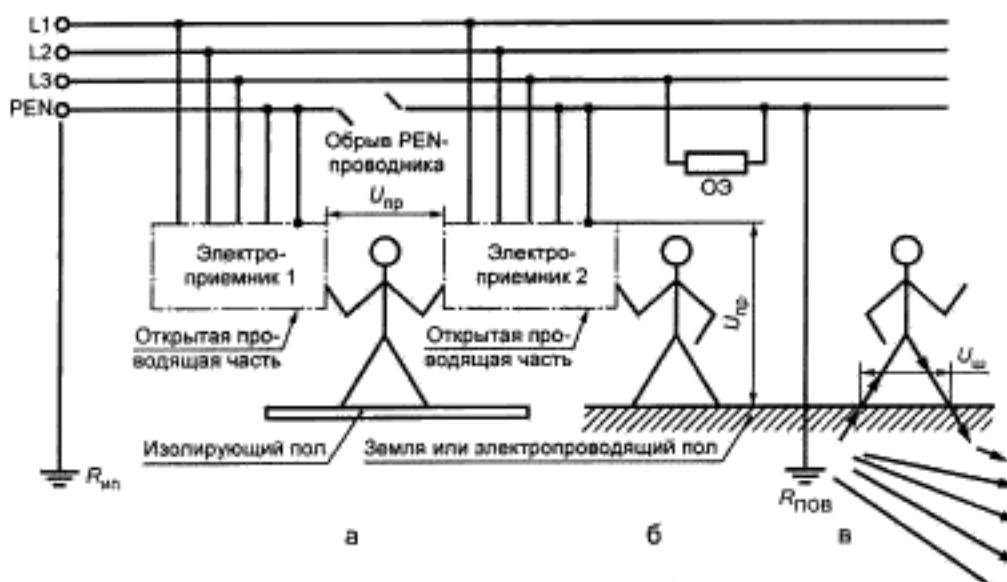
Рисунок В.1 — Сеть TN-C с оборванным PEN-проводником.
