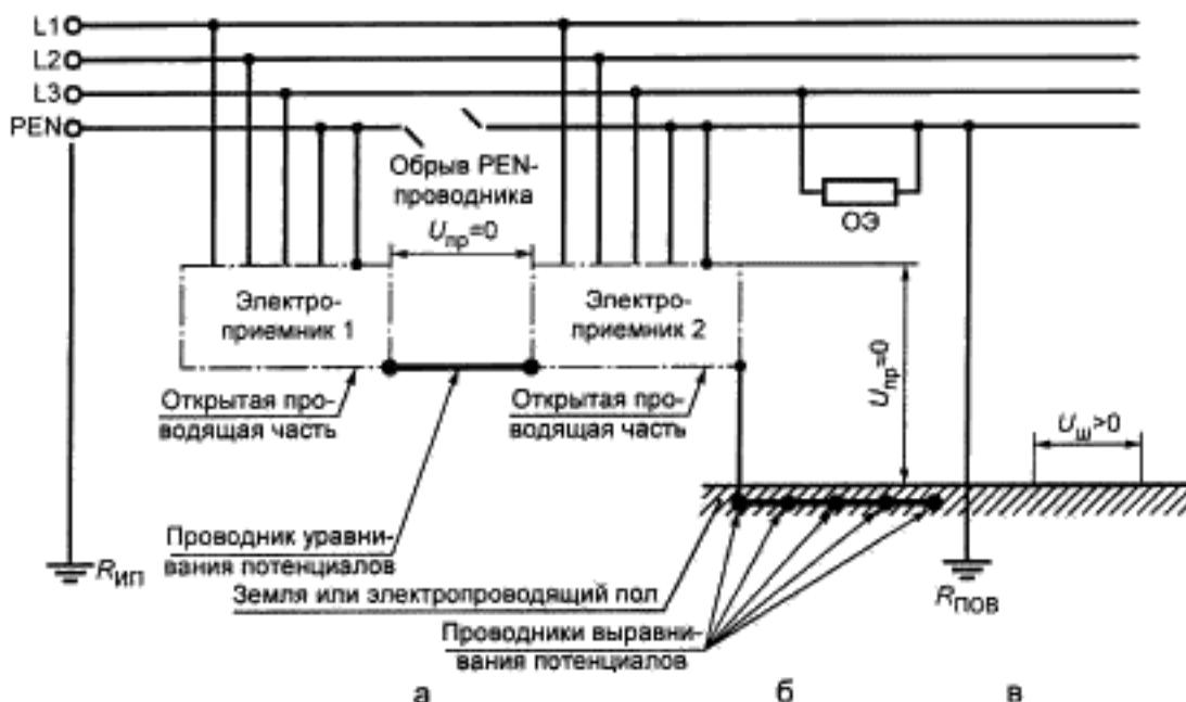
Рисунок В.2 — Сеть TN-C с оборванным PEN-проводником
