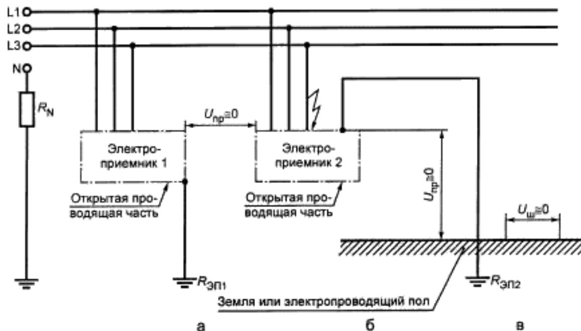
Рисунок В.12 — Сеть ИТ с заземлением нейтрали источника питания через сопротивление с однофазным замыканием на корпус
