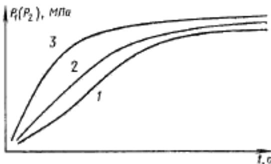
1—давление набухания при температуре воды (жидкости)  $20\pm2^\circ\text{C}$ ; 2—давление набухания при температуре воды (жидкости)  $50\pm2^\circ\text{C}$ ; 3—давление набухания при температуре воды (жидкости)  $90\pm2^\circ\text{C}$ .
