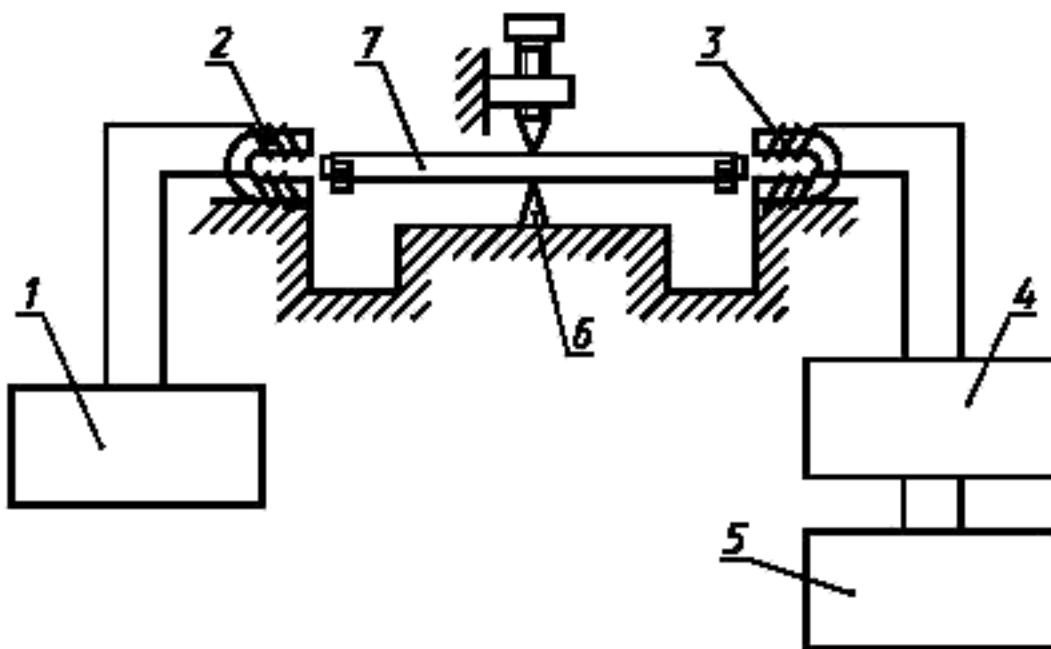
1 — генератор сигналов; 2 — электромагнитный возбудитель колебаний; 3 — электромагнитный датчик колебаний; 4 — электронный милливольтметр по ГОСТ 22261—94; 5 — частотомер по ГОСТ 7590—93; 6 — опорное устройство, 7 — образец с ферромагнитными пластинками
