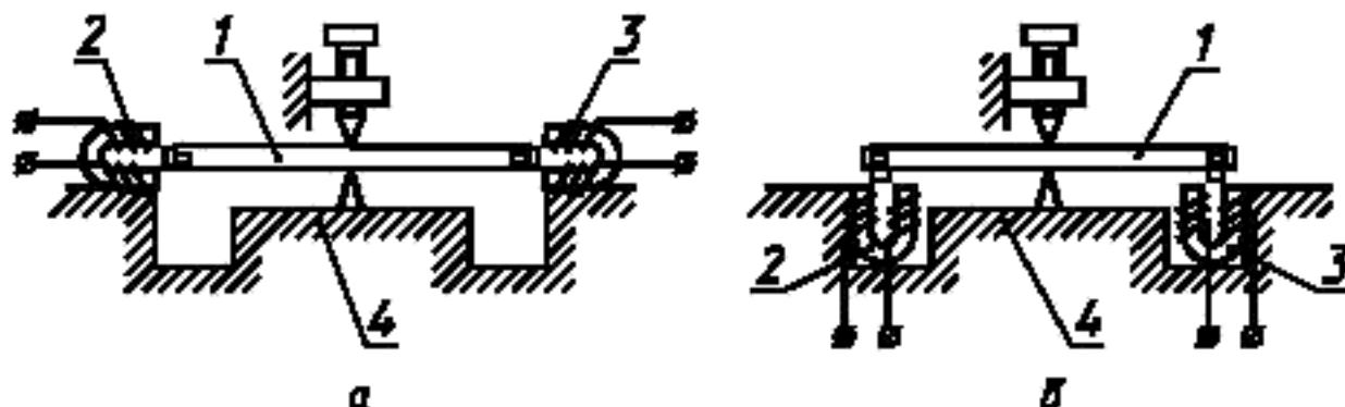
1 — образец; 2 — возбудитель колебаний; 3 — датчик колебаний; 4 — опорное устройство
