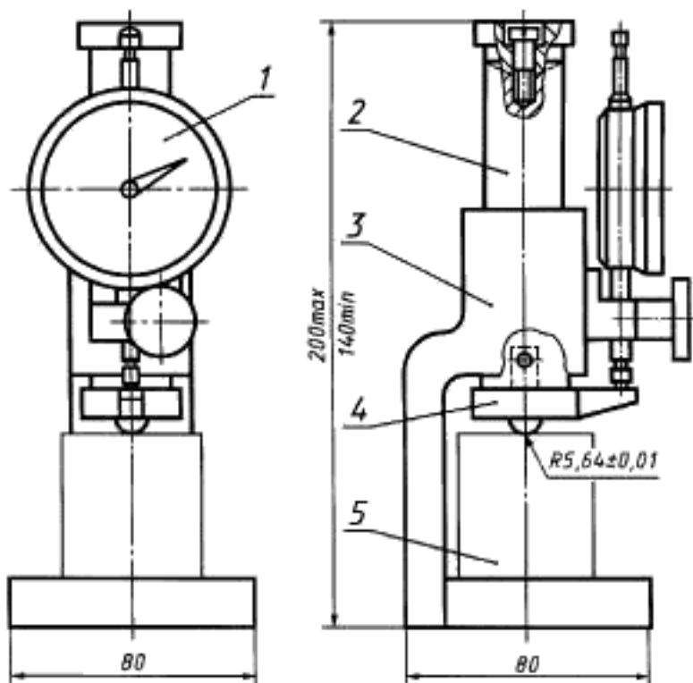
1 — индикатор; 2 — шток; 3 — корпус; 4 — съемный пuhanсон; 5 — образец
