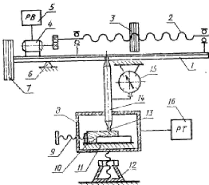
1—рычаг двухходечий; 2—винт перемещения груза; 3—подавимой груза; 4—рециркуляционный двигатель с фрикционной передачей; 5—редуктор времени; 6—шариковая опора рычага; 7—противовес; 8—камера; 9—микрометрический винт перемещения образца; 10—испытуемый образец; 11—направляющая образца; 12—винтовой подъемник; 13—шарик; 14—удерживающий шток; 15—индикатор; 16—автоматический регулятор температур
