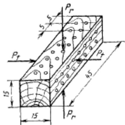
$P_r$  — действие нагрузки в радиальном направлении;  $P_t$  — действие нагрузки в тангенциальном направлении
