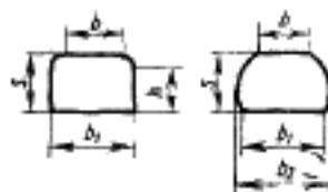
б —ширина верхней пласти; б<sub>2</sub> —ширина нижней пласти; б<sub>3</sub> —ширина шпалы по непропитанным сторонам; д —толщина шпалы; д<sub>1</sub> —высота пропиленной части боковых сторон
