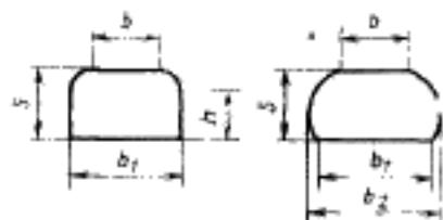
*b*—ширина верхней пласти; *b<sub>1</sub>*—ширина нижней пласти; *b<sub>2</sub>*—ширина бруса по непропиленным сторонам; *s*—толщина бруса; *h*—высота пропиленной части боковой стороны
