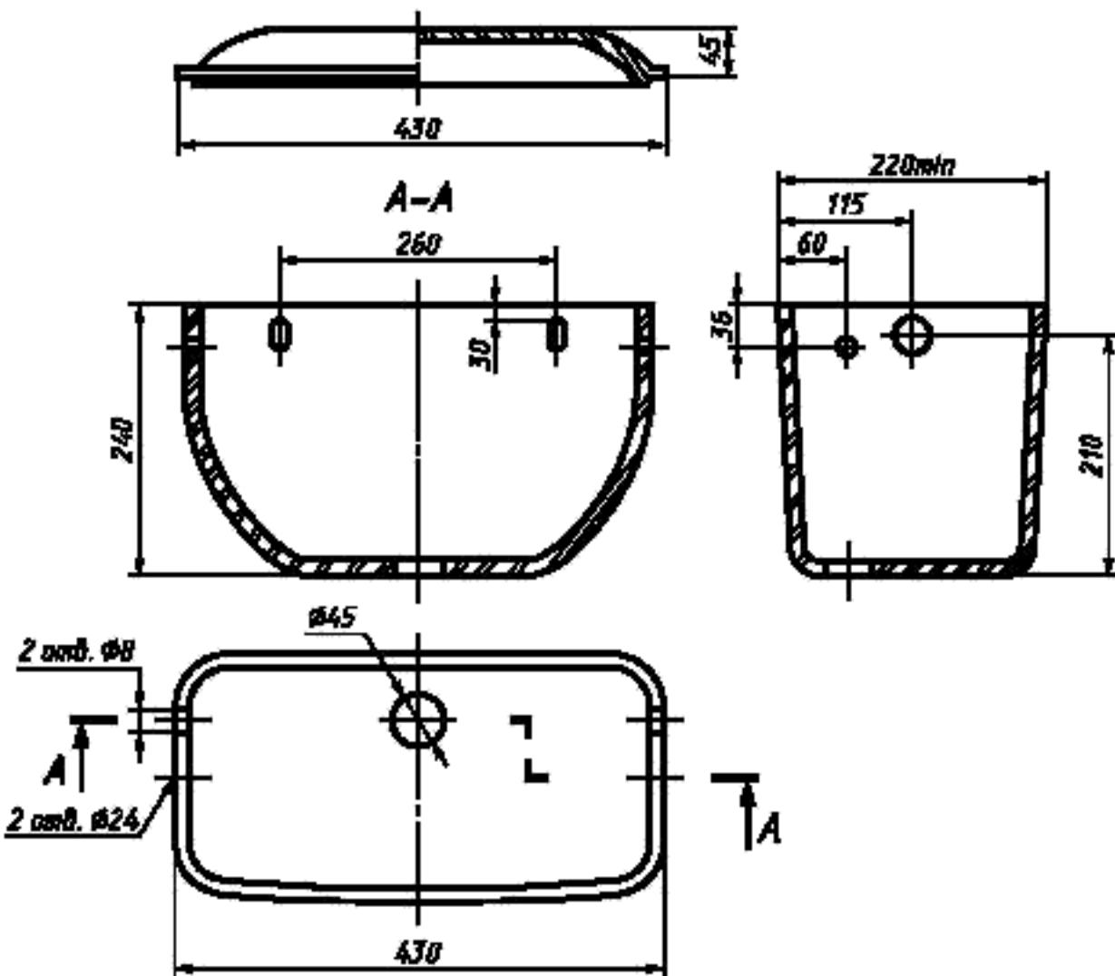
Рисунок 10 — Бачок смывной высокорасполагаемый с боковым пуском
