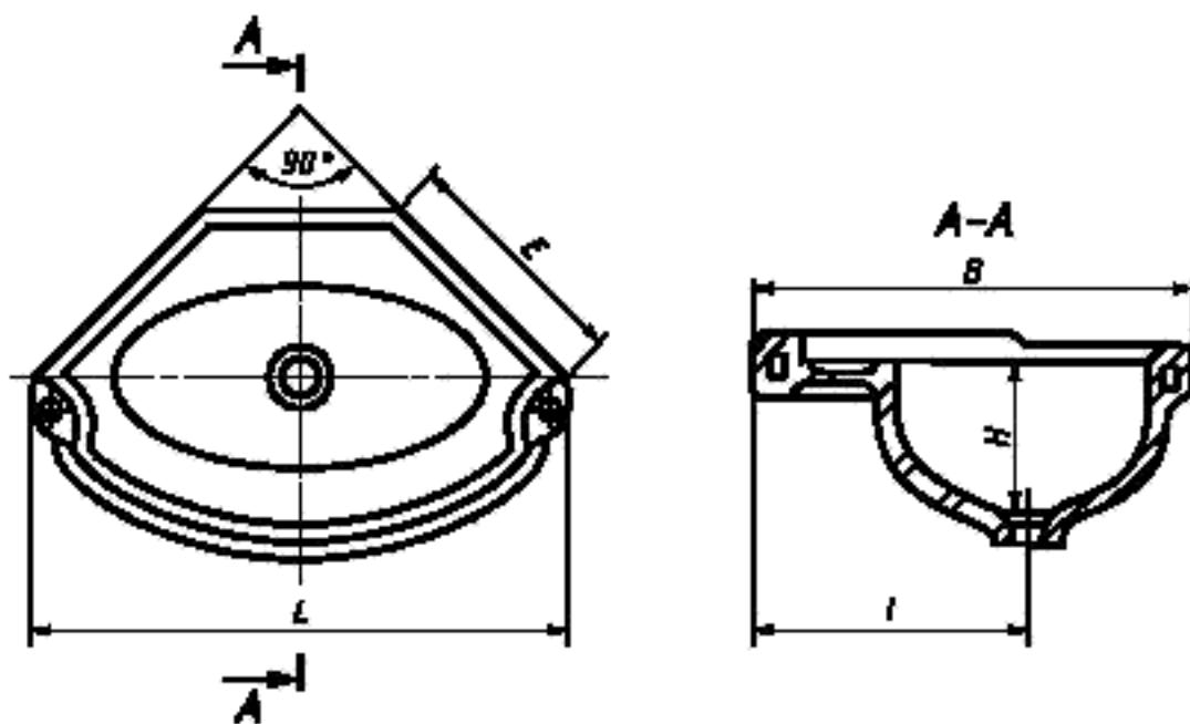
Рисунок 2 — Умывальник для железнодорожных вагонов
