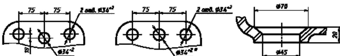
Рисунок 12 — Расположение и размеры отверстий в биде
