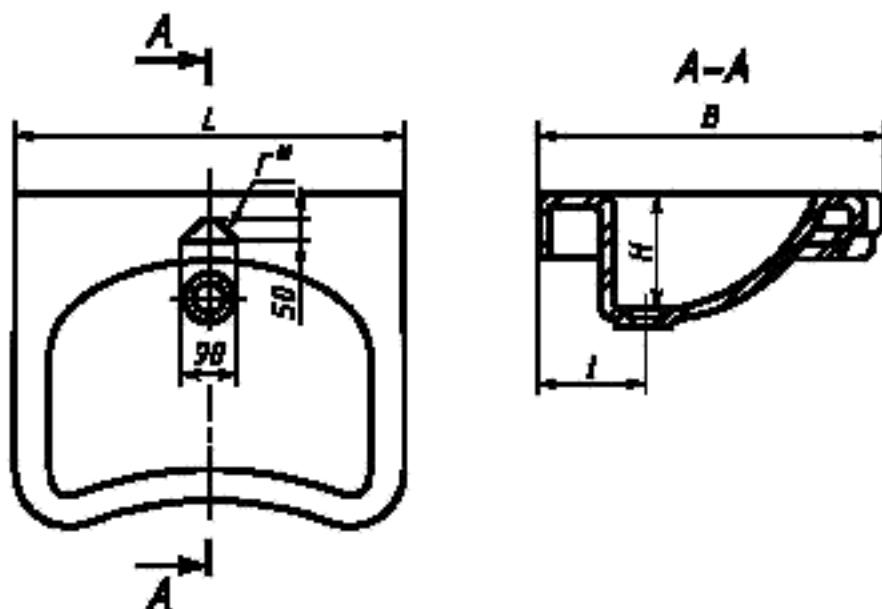
\* Отверстие  $\Gamma$  — только в парикмахерском умывальнике.
