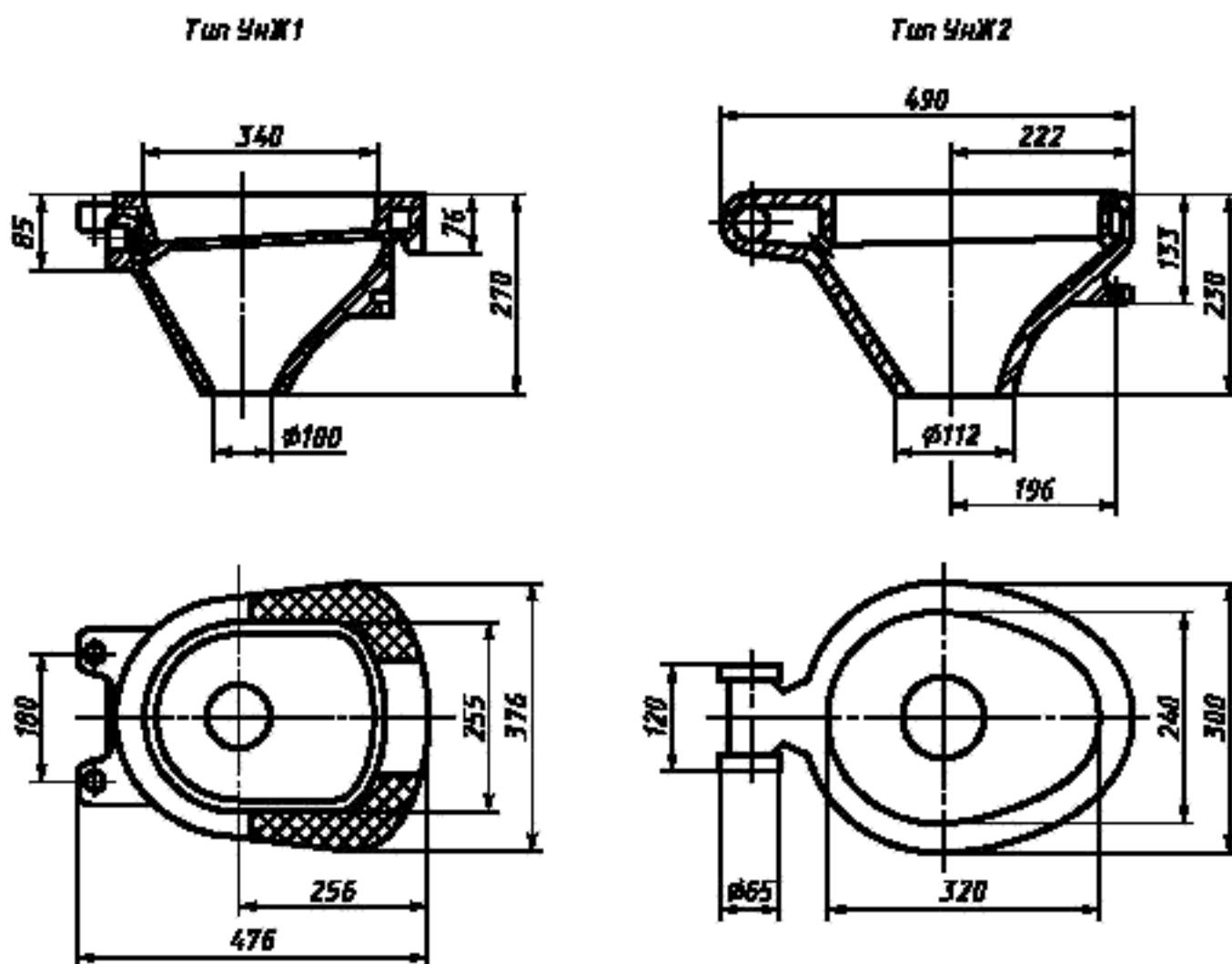
Рисунок 9 — Унитазы, устанавливаемые в санитарных узлах железнодорожных вагонов
