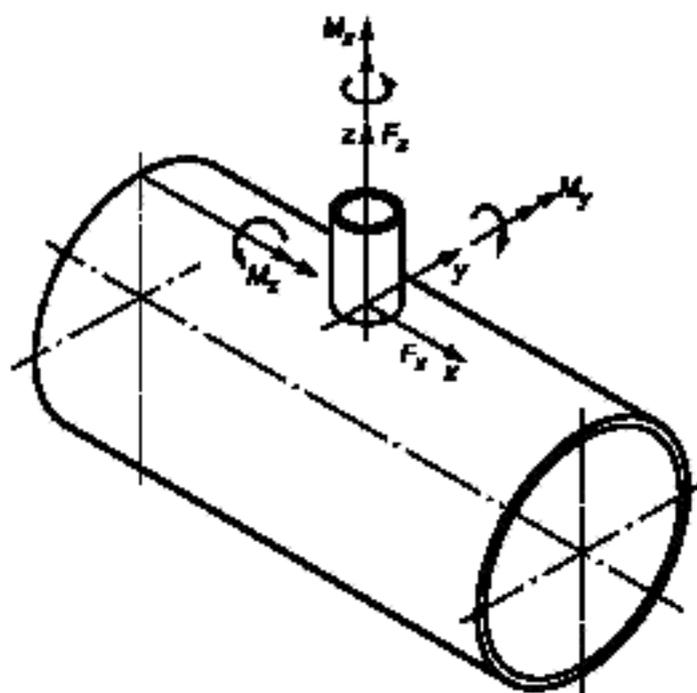
Рисунок 1 — Схема нагружения штуцера внешними нагрузками
