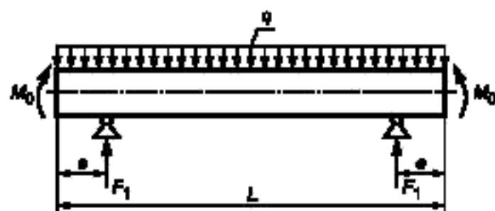
Рисунок 10 — Расчетная схема определения усилий
