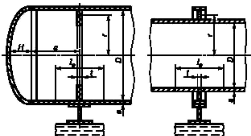
*б* — цилиндрическая обечайка, подкрепленная кольцами жесткости
