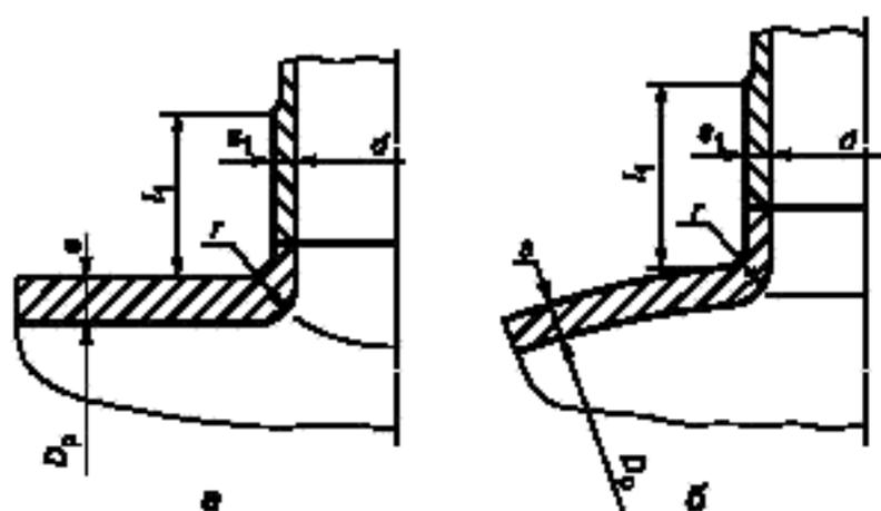
Рисунок А.9 — Укрепление отверстий отбортовкой
