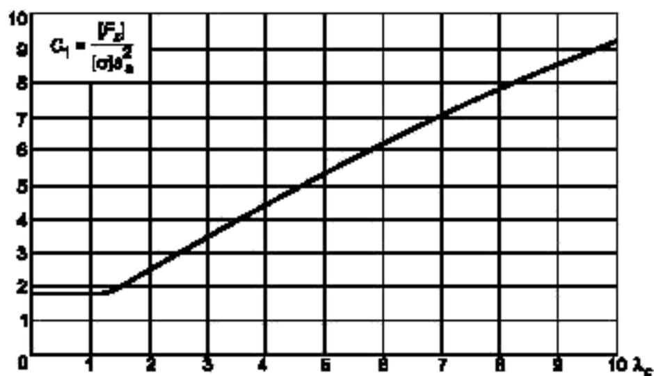
Рисунок А.16 — График для определения  $C_1$
