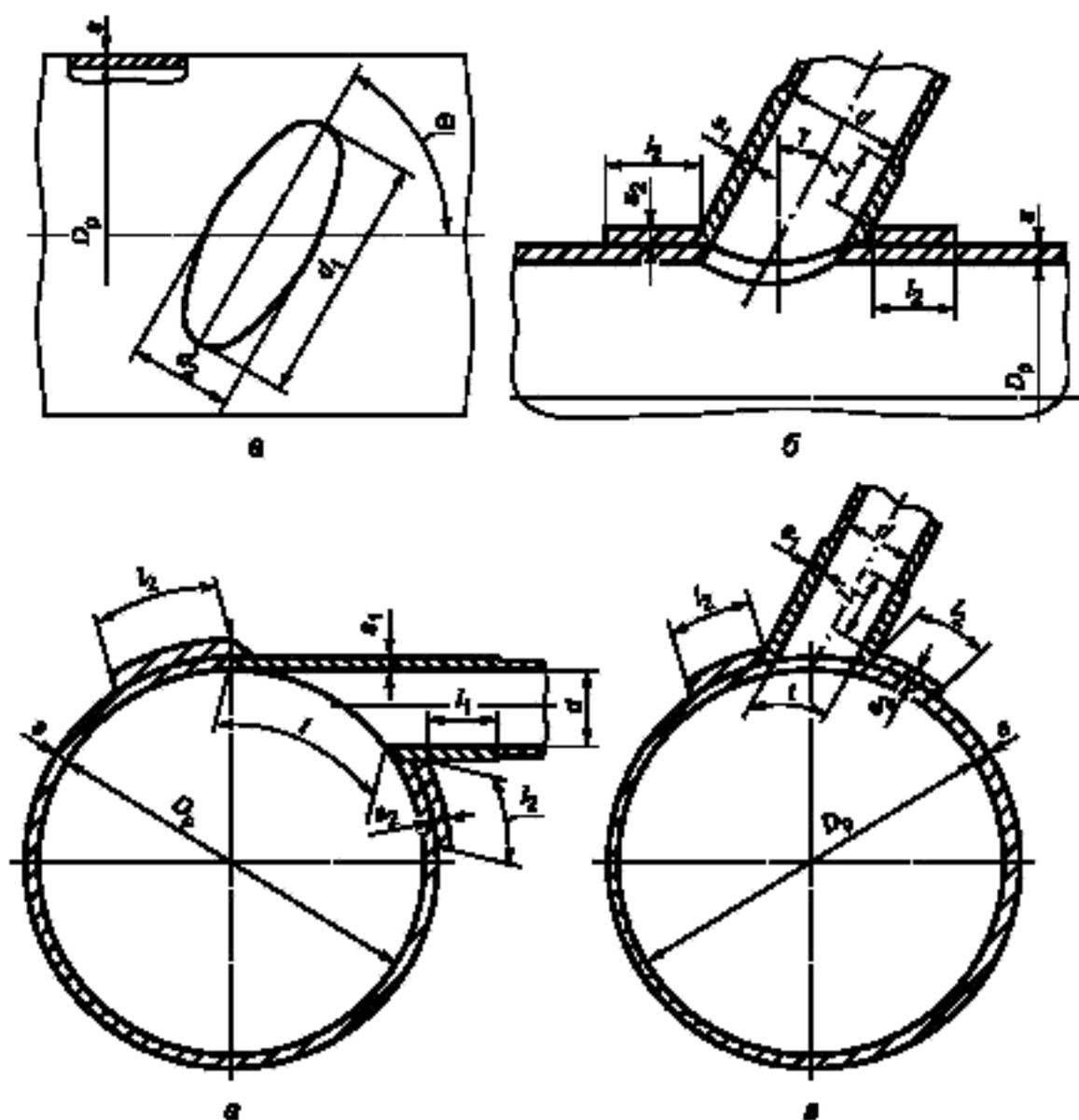
Рисунок А.11 — Наклонные штуцера на обечайке
