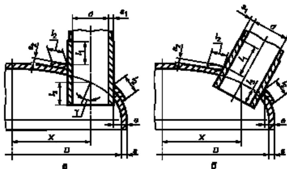
Рисунок А.5 — Смещенные штуцера на выпуклом днище
