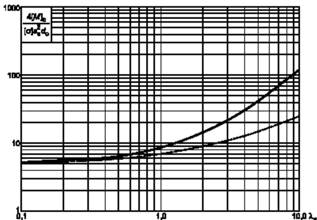
Рисунок А.20 — График для определения  $[M_0]$
