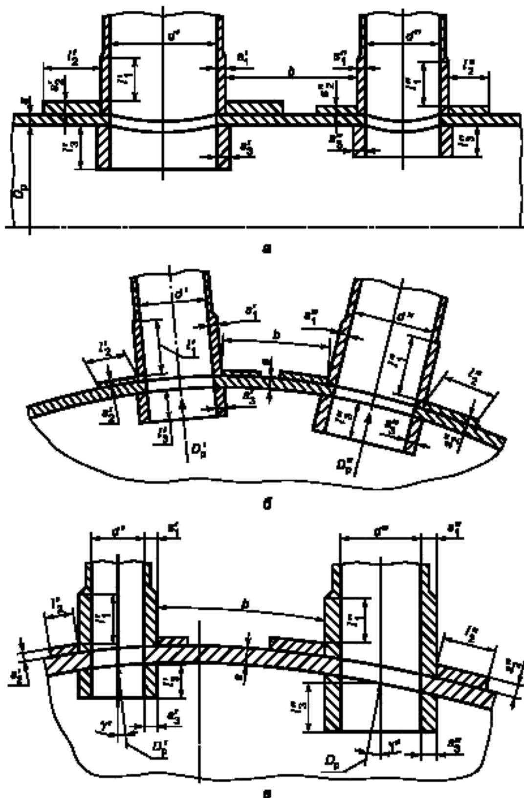
Рисунок А.2 — Укрепление взаимовлияющих отверстий
