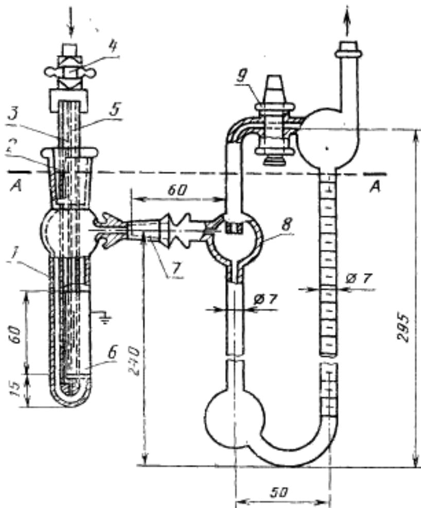
1 — реакционная камера; 2 — фторопластовая пробка; 3 — капиллярная трубка; 4 — выпускной кран; 5 — полый электрод; 6 — заземленный электрод; 7 — конусообразное соединение; 8 — газовая burette; 9 — запорный кран;
