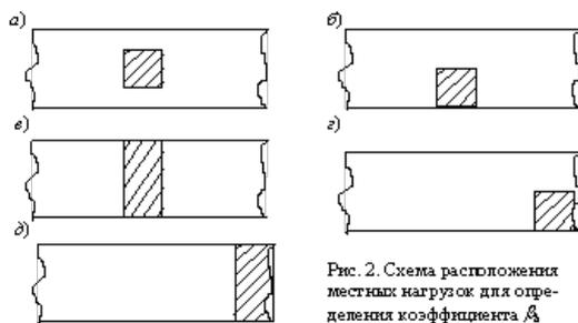
Рис. 2. Схема расположения местных нагрузок для определения коэффициента  $g_{ec}$
