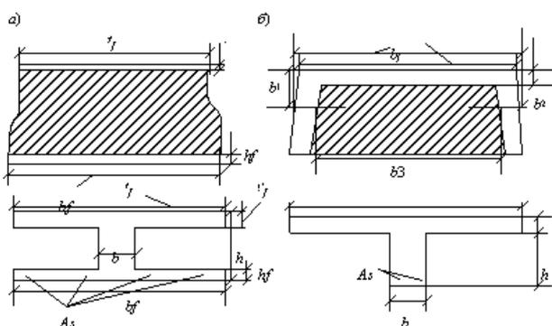
Рис. 4 . Схема поперечных сечений составных элементов
