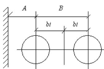
**Расстояния между осями смежных трубопроводов и от трубопроводов до стенок каналов, тоннелей, галерей и стен зданий, м**
