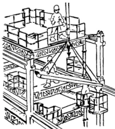
По команде монтажника М<sub>1</sub> машинист крана медленно опускает панель на опоры, а монтажник М<sub>2</sub>, придерживает ее сбоку. При необходимости он ломом рихтует опорную часть панели так, чтобы закладные детали ее и ригеля совпали. Другой конец
