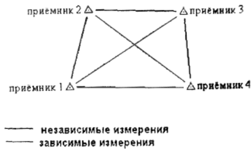
Рис. 2. Схема, иллюстрирующая проект независимого определения 3-х линий из сеанса, выполняемого на 4-х пунктах
